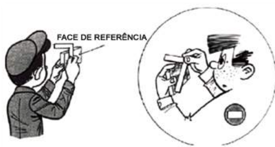
Figura 22 - Colocação do esquadro para a verificação de esquadria entre duas faces de uma peça.
