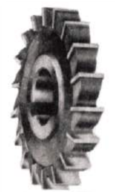
Figura 15 - Fresa circular de corte de três lados e dentes retos.
