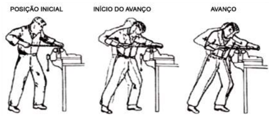
Figura 20 - Posição do corpo e a forma de trabalho durante a utilização de uma lima.
