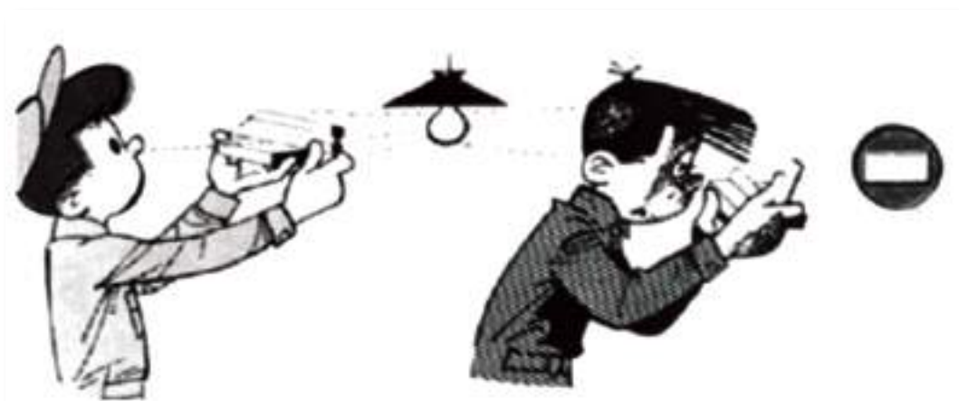
Figura 24 - Verificação da planeza da face de uma peça.
