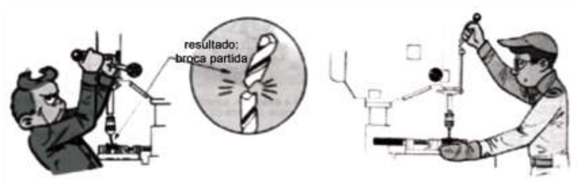
Figura 31 - Realização do movimento de penetração da broca.
