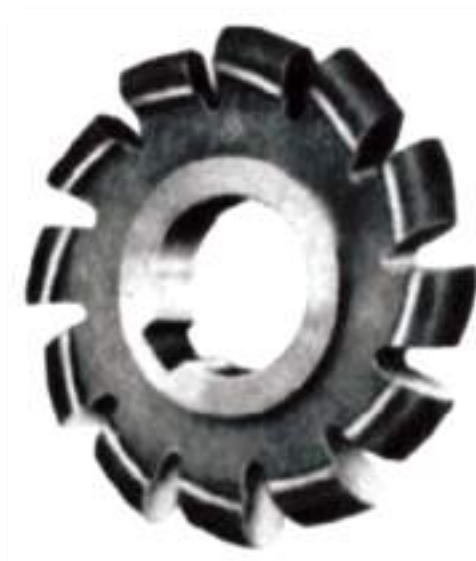
Figura 24 - Fresa de perfil constante semi-circular convexa.
