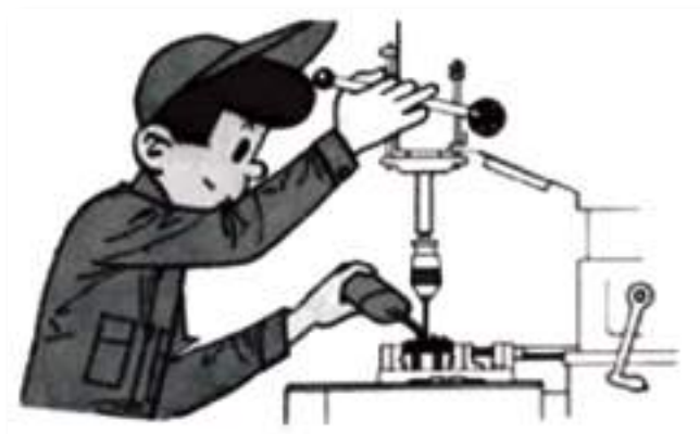
Figura 33 - Lubrificação manual da peça e da broca durante a furação.
