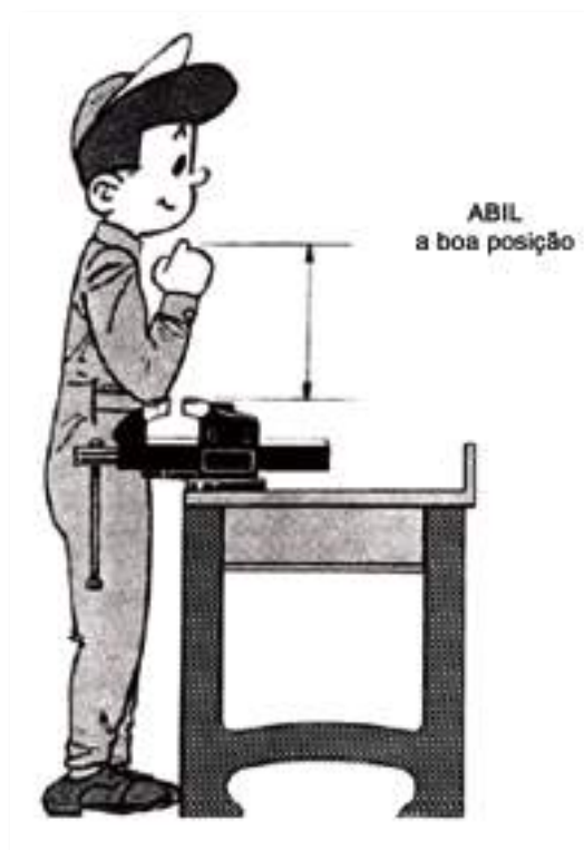
Figura 15 - Posição, em altura, para realizar uma limagem.
