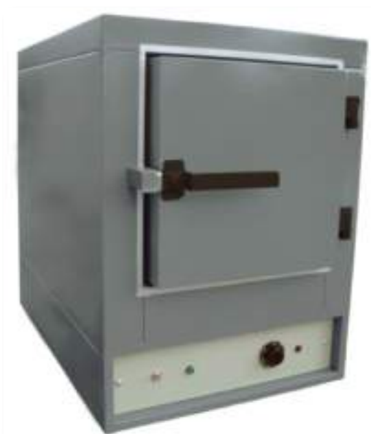
Figura 8 - Estufa de secagem e conservação de elétrodos.
