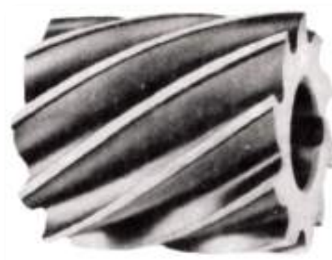
Figura 11 - Disposição dos dentes das fresas.
