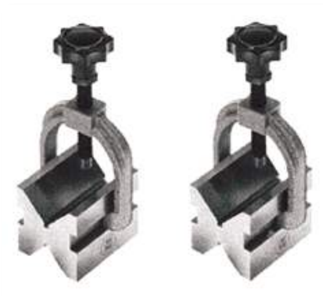
Figura 32 - Calços prismáticos com cinta de aperto normalmente utilizados para a traçagem de escatéis em veios.
