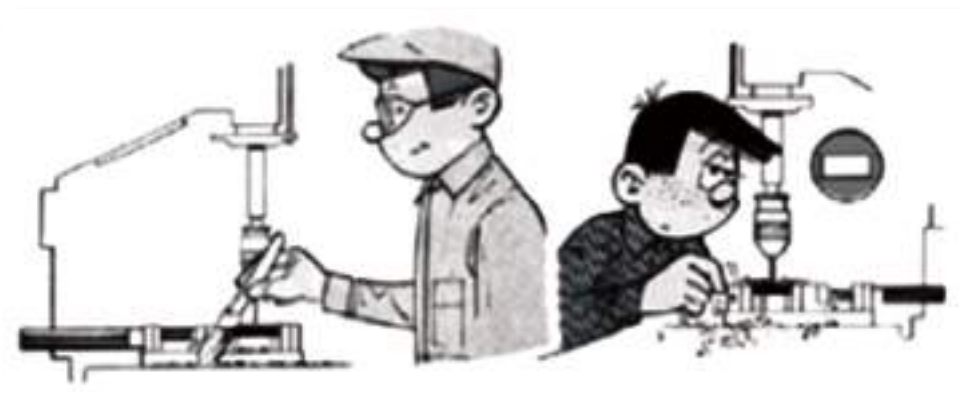
Figura 32 - Retirar as aparas durante a furação.
