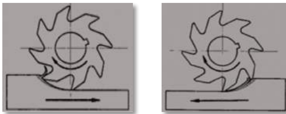
Figura 5 - Fresamento a favor e contra o material.
