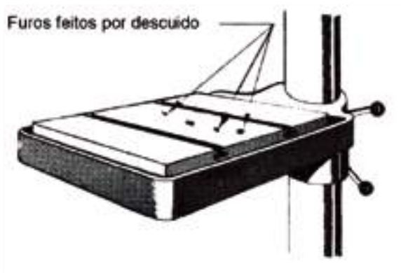
Figura 28 - Furos feitos por descuido na mesa do engenho de furar.
