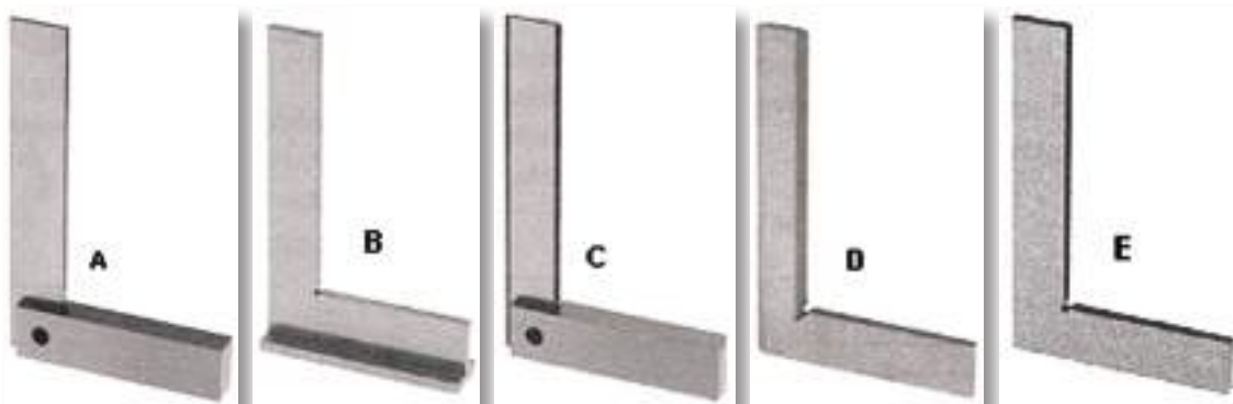
Figura 12 - Tipos de esquadros: A - Esquadro de cepo; B - Esquadro T; C - Esquadro de cepo com lâmina biselada; E - Esquadro liso.
