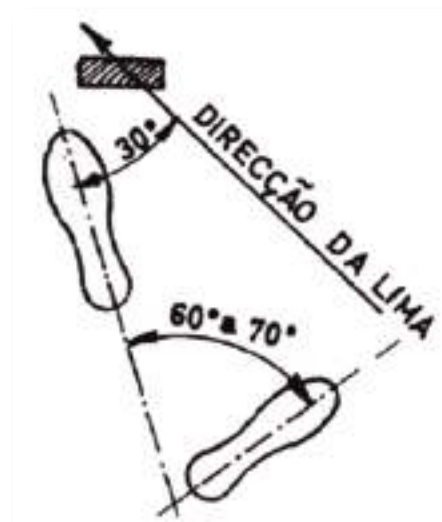
Figura 16 - Posição correta dos pés ao realizar uma limagem.
