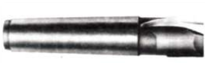
Figura 18 - Fresa de topo de haste cônica.
