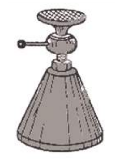
Figura 33 - Macaco de altura variável cuja base de apoio da peça é de forma plana.
